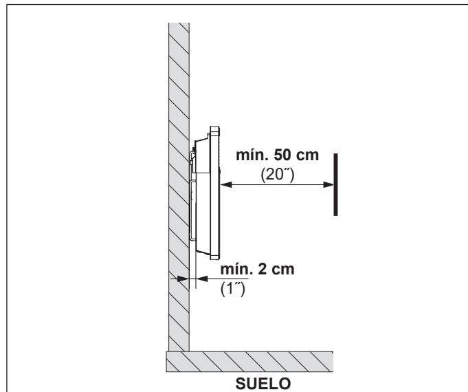
» La imagen de arriba muestra las distancias mínimas permitidas entre el aparato instalado y cualquier superficie dura.
