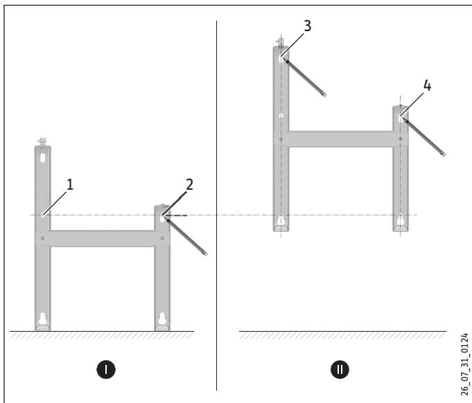
» Percez les trous pour chacun des quatre repères. Fixez le support mural à l'aide de la quincaillerie appropriée (vis, chevilles) en fonction du type de cloison. Avec les fentes verticales, vous pouvez compenser un trou de fixation légèrement décalé.
