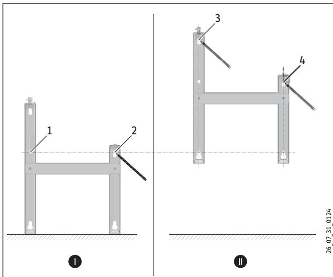
» Perfore la pared en los cuatro puntos marcados utilizando un taladro. Asegure el soporte con implementos adecuados (tornillos, tacos) dependiendo del tipo de pared. Las ranuras verticales le permiten compensar desplazamientos en los orificios de sujeción.
