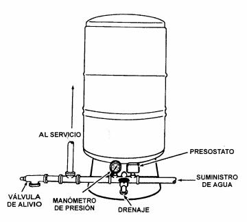
El tanque de sistema de agua debe instalarse lo más cerca posible del presostato (a 24 pulgadas o menos), a fin de reducir los efectos adversos de las pérdidas por fricción y las diferencias de elevación.
