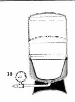
1. Avant l'expédition, le réservoir reçoit une pression de précharge standard, précisée à la rubrique « Fonctionnement » du présent manuel.
