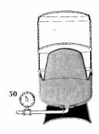
3. La pression du réservoir augmente. L'admission d'eau se poursuit jusqu'à ce que la pression de coupure de la pompe soit atteinte. La pompe s'arrête, et le réservoir est maintenant plein.
