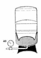
2. À mesure que de l'eau est admise dans le réservoir, l'air situé au-dessus de la membrane se comprime et son volume diminue en fonction de celui de l'eau.
