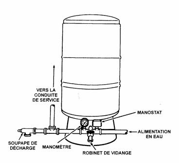
Il faut installer le réservoir le plus près possible du manostat (24 po/ 61 cm ou moins) pour réduire l'incidence de la perte de charge par frottement et de la dénivellation.
