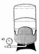
4. En raison de la pression d'air dans la chambre étanche, l'eau s'engage dans le système lorsqu'une demande se produit sans entraîner la mise en marche immédiate de la pompe. La pression dans la chambre diminue jusqu'à atteindre la pression d'enclenchement de la pompe. Le manostat active alors la pompe, qui exécute le cycle de remplissage.
