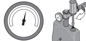
C- Fermez la vanne de régulation jusqu'à ce que la pression se stabilise
