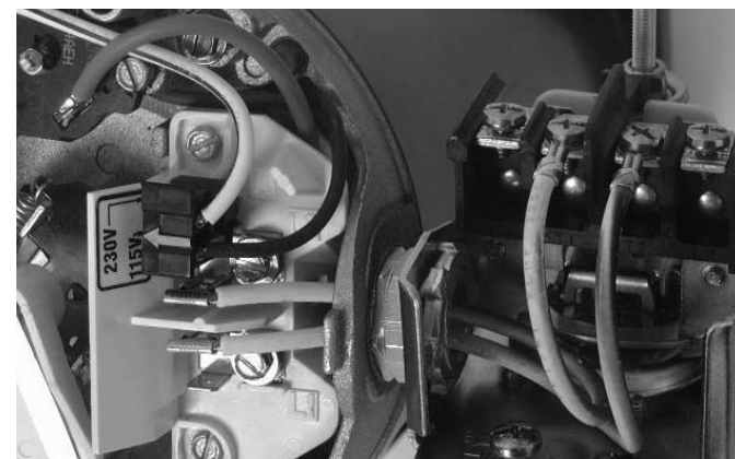
Figura 11: Voltaje configurado a 115 voltios, tipo dial
