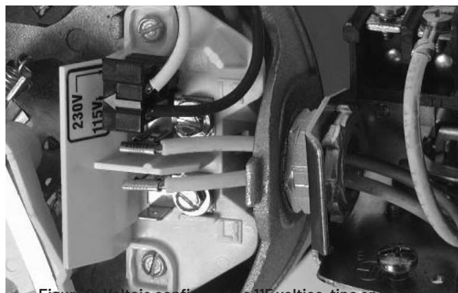
Figura 9: Voltaje configurado a 115 voltios, tipo enchufe
