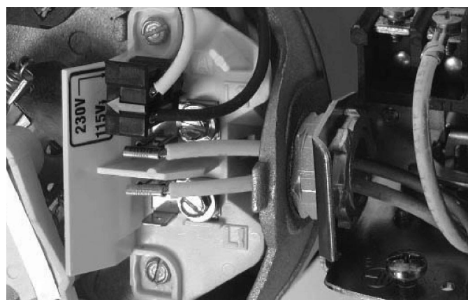
Figure 9 : Tension réglée à 115 volts, type de fiche
