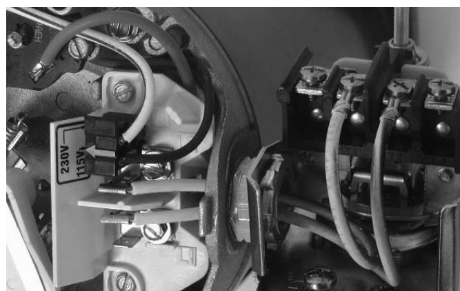
Figure 11 : Tension réglée à 115 volts, type de cadran
