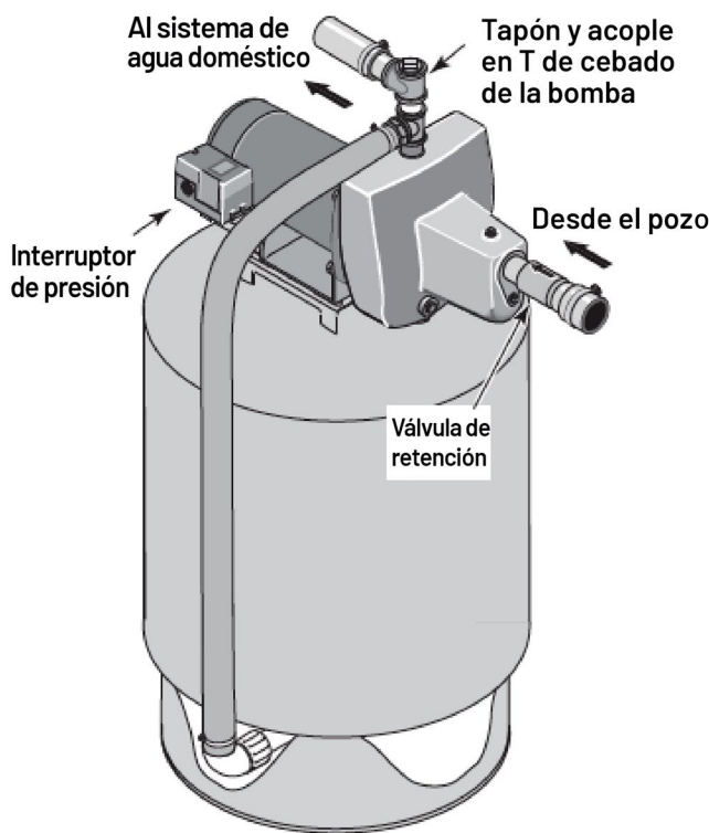
Figura 4: Conexiones del tanque previamente cargado
